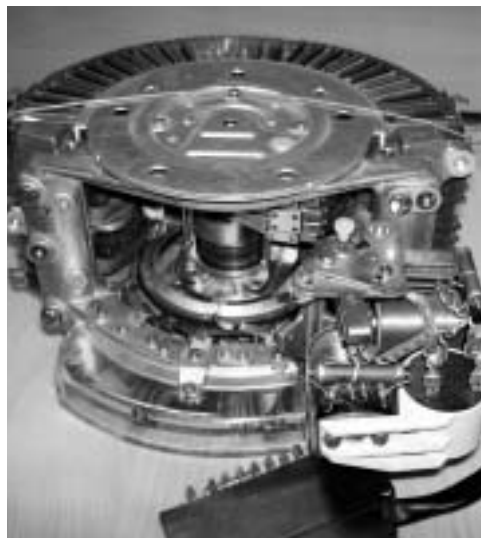
Abb. 18. Edelmetall-Motor-Drehwähler S55, in Krefeld von 1955 bis zum 19. Dezember 1996 eingesetzt (vollständige Digitalisierung aller Vermittlungsstellen, Auswechslung aller Einrichtungen gegen Digitaltechnik).
