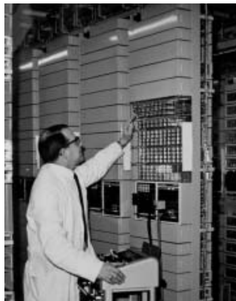
Abb. 36. Ein Knotenregister mit Magnetkernspeicher aus dem Fernwahlsystem 64 (eingeführt 1964) wird vom Autor dieses Aufsatzes überprüft.
