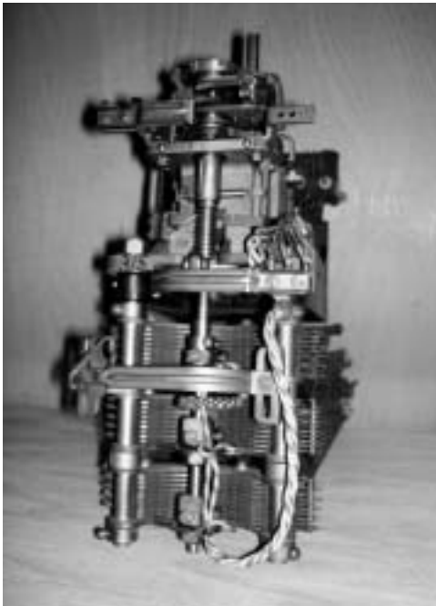
Abb. 15. Elektro-mechanischer Hebdrehwähler System 22, Weiterentwicklung des Strowger-Wählers.
