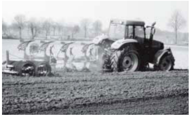
Abb. 26. 4-Schar-Wendepflug mit Ringelwalze von Lemken, Alpen
