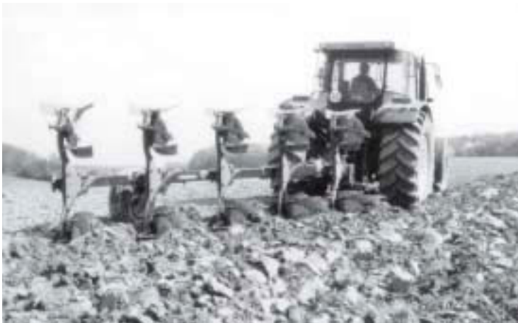
Abb. 24. 5-Schar-Wendepflug auf schwerem Boden von Lemken, Alpen
