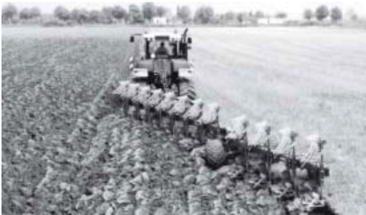
Abb. 24. 5-Schar-Wendepflug auf schwerem Boden von Lemken, Alpen
